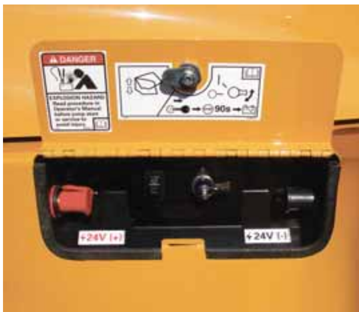
Переключатели открывания капота и аккумулятора. При разряде аккумулятора капот может быть открыт снаружи путем подключения к внешнему источнику
